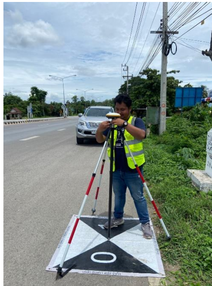
รูปที่ 3-13 การรังวัดค่าพิกัดจุดควบคุมภาพถ่ายด้วยเครื่องรับสัญญาณดาวเทียม GNSS
