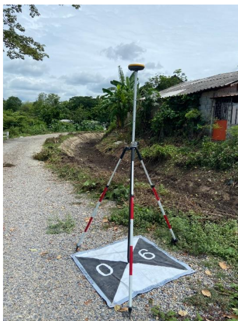
รูปที่ 3-21 การรังวัดค่าพิกัดจุดควบคุมภาคพื้นดินด้วยเครื่องรับสัญญาณดาวเทียม GNSS
