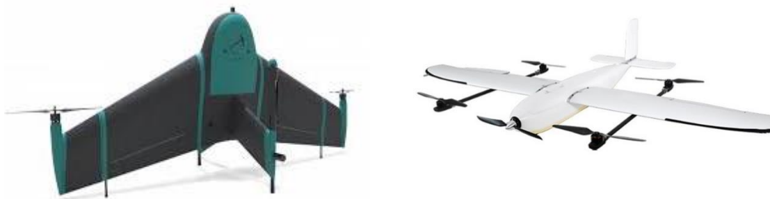
รูปที่ 2-13 ตัวอย่างอากาศยานไร้คนขับชนิดปีกตรึงขึ้นลงแนวดิ่ง (Fixed-Wing Hybrid)
